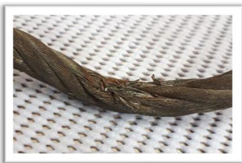
Rotura concentrada de alambres
