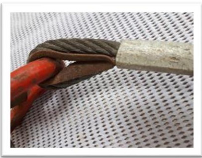
Óxido en guardacabos
