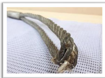
Aplastamiento de gaza. Presencia exterior del "alma"
